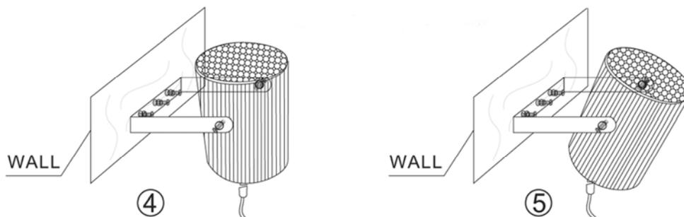
4. Le projecteur peut être orienté à  $\pm 90^\circ$  par rapport au mur. Pour figer le projecteur, vous devez utiliser les deux vis de fixation du projecteur
