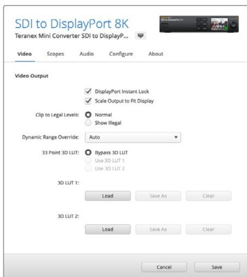
Regola le impostazioni su Blackmagic Teranex Setup per sincronizzare il segnale video all'istante su DisplayPort quando si connettono o instradano diverse fonti, caricare LUT 3D e regolare i livelli del segnale audio analogico in uscita tramite RCA
