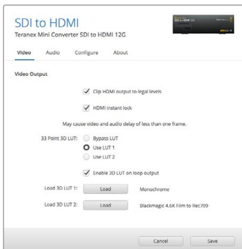
Blackmagic Teranex Setup consente di abilitare Instant Lock HDMI, che sincronizza il segnale video all'istante quando si connettono o instradano diverse fonti, caricare LUT 3D, regolare i livelli del segnale audio analogico di uscita tramite XLR, e non solo
