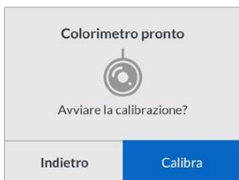
3.15 Il processo di calibrazione ha inizio, e dura 10-15 minuti. Teranex Mini SDI to DisplayPort 8K HDR genera e misura un'ampia gamma di colori secondo i valori di luminanza, mettendo a confronto i risultati forniti dalla misurazione e i valori previsti. A operazione completata, genera una LUT 3D di calibrazione e mostra un messaggio di conferma.
