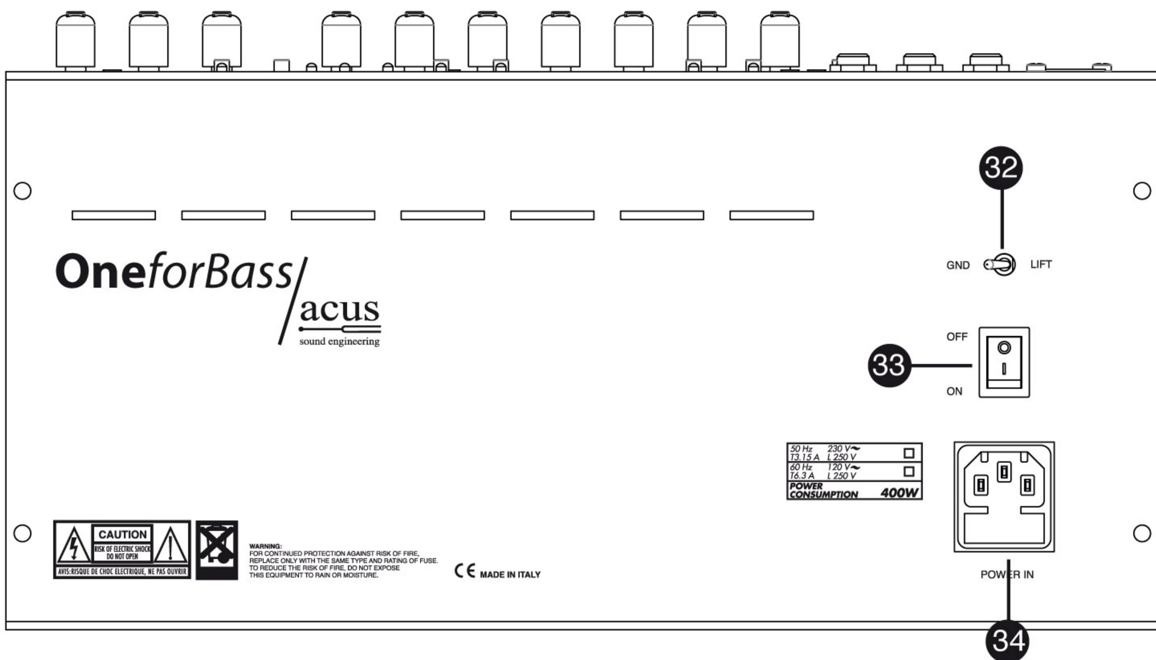
**32- GND LIFT:** interruttore della messa a terra del circuito elettronico. Invertire la posizione in caso di ronzii generati dalla rete.
