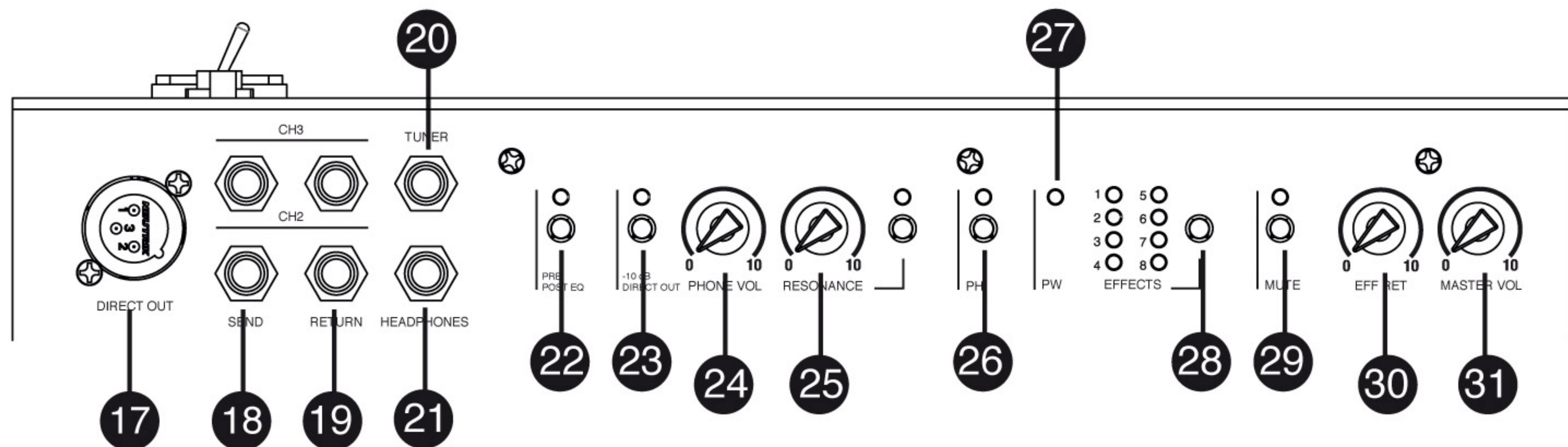
**17-DIRECT OUT:** Uscita bilanciata. Il suo livello è indipendente dal volume master ma è funzione della posizione dello switch -10dB Direct Out.
