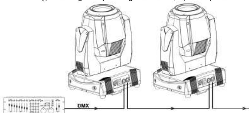
Na końcu ostatniego urządzenia należy wpiąć terminator DMX. Jest to niewielkie urządzenie wyglądające jak wtyk XLR, w którym piny 2 oraz 3 są połączone ze sobą oraz opornikiem 120 Ohm.
