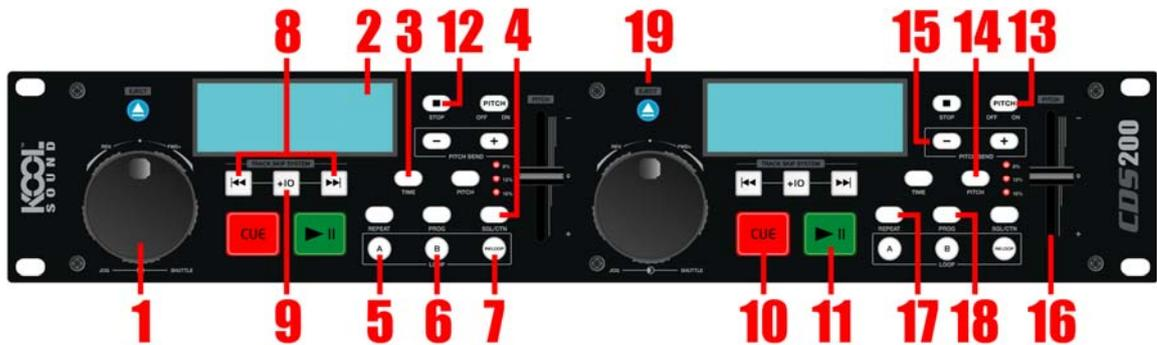
1. **Molette JOG & SHUTTLE** : Cette molette (WHEEL en anglais) se compose d'une roue centrale (JOG) et d'un volant (SHUTTLE).
