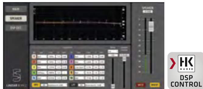
Screenshot del software di controllo remoto DSP CONTROL, disponibile gratuitamente nell'area download dei prodotti LINEAR 5 su www.hkaudio.com . I parametri per "Speaker" e "DSP Out" sono identici, ma possono essere configurati indipendentemente grazie al DSP raddoppiato.
