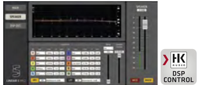
Captura de pantalla del software remoto DSP CONTROL. Es posible descargar gratuitamente este software desde la página de descargas de LINEAR 5 en www.hkaudio.com . Los parámetros del altavoz y de la salida DSP son idénticos, pero la doble potencia DSP permite configurar cada conjunto de forma independiente.
