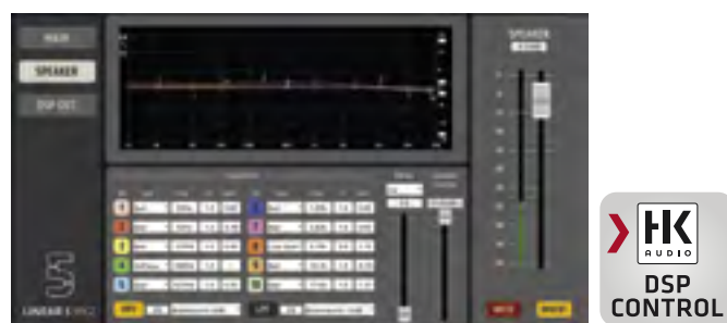
Capture d'écran du logiciel de commande à distance DSP CONTROL, disponible gratuitement dans la section de téléchargement des produits LINEAR 5 sur www.hkaudio.com . Les paramètres sont identiques pour « Speaker » (enceinte) et « DSP Out », mais peuvent être configurés indépendamment pour les deux grâce à la double fonctionnalité du DSP.
