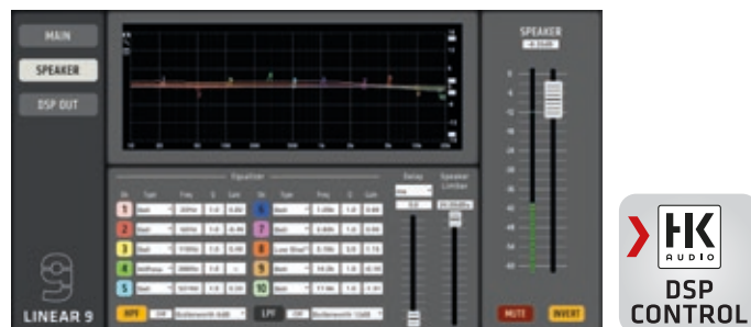
Screenshot der Remote-Software DSP CONTROL, welche im Download-Bereich der LINEAR 9-Produkte auf www.hkaudio.com kostenlos zur Verfügung steht. Die Parameter für „Speaker“ und „DSP Out“ sind identisch, können aber dank doppelter DSP-Power unabhängig voneinander konfiguriert werden.
