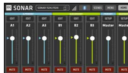
Dos SONAR Xi en el modo Zone: hay disponible un Fader canal 3 y un volumen Master para cada SONAR Xi
