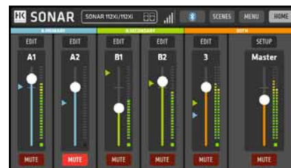
Dos SONAR Xi en el modo estéreo: el canal 3 y el volumen Master se controlan de forma conjunta
