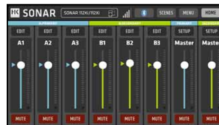
Deux SONAR Xi en mode zone : chaque SONAR Xi possède son propre fader de canal 3 et son volume Master
