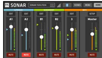
Deux SONAR Xi en mode stéréo : Le canal 3 et le volume Master sont gérés ensemble
