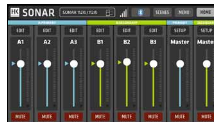
Zwei SONAR Xi im Zone-Mode: für jede SONAR Xi steht ein eigener Kanal 3-Fader und ein Master-Volume zur Verfügung
