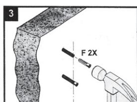
Inserite due tasselli aiutandovi con un martello per allinearli al foro. Fissate la staffa fissandola tramite le viti che si agganceranno ai tasselli.
