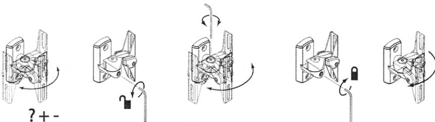
Due viti permettono il bloccaggio della staffa in posizione desiderata. E' sufficiente agire con la chiave a brugola allentando e stringendo le due viti come mostrato nella figura sovrastante.
