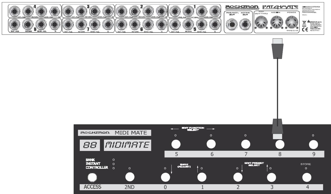
L'alimentazione PHANTOM è fornita per alimentare esclusivamente tutti i CONTROLLER MIDI di ROCKTRON. Fate riferimento ai vostri manuali prima di tentare di usare questa caratteristica con un CONTROLLER MIDI diverso. Rocktron non può essere responsabile dei danni arrecati in seguito all'uso di collegamenti impropri.
