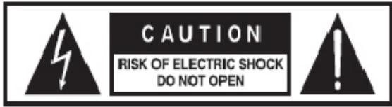
**ATTENZIONE:** per ridurre il rischio di shock elettrico, non rimuovere la copertura superiore o il pannello posteriore. Non aprire l'unità, per eventuali riparazioni rivolgersi a personale qualificato. Per ridurre il rischio di incendio e scariche elettriche non esporre l'unità a pioggia o umidità.
