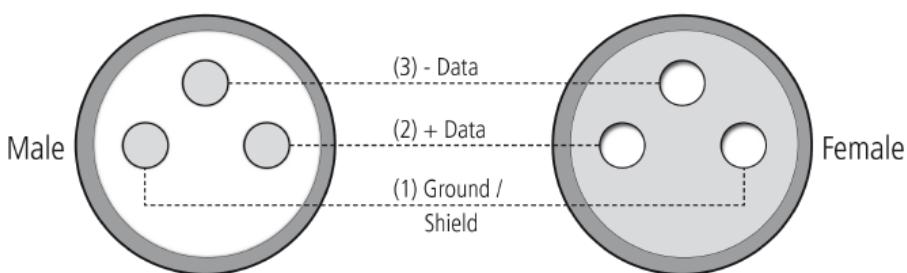
Resistencia 120 ohmios // ¼ w entre el pin 2 (DMX-) y el pin 3 (DMX+) del último dispositivo.
