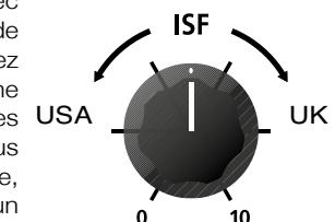
Contrairement aux commandes de « Contour » conventionnelles et aux systèmes d'égalisation paramétrique, les réglages Bass, Middle et Treble continuent d'interagir les uns avec les autres tout comme dans un réseau de correction traditionnel d'amplificateur de guitare. Cela permet d'avoir une réponse très familière et musicale.
