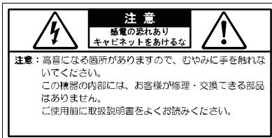
このマークは、機器の内部に絶縁されていない「危険な電圧」が存在し、感電の危険があることを警告しています。
