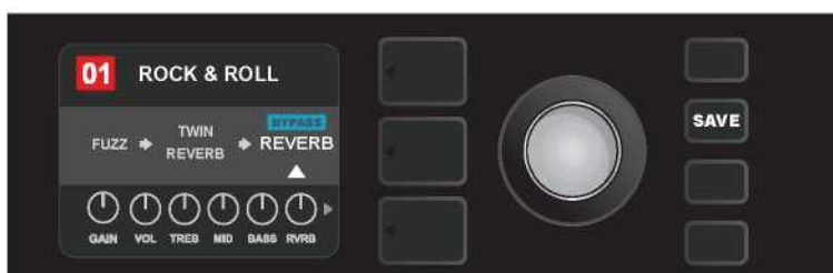
Con l'effetto bypassato (come indicato qui dalla freccia bianca sotto di esso e dalla casella blu contenente l'etichetta "BYPASS" sopra di esso), continuare a modificare altri parametri, oppure premere il pulsante illuminato SAVE (salva) per lasciare attive le modifiche completate.
