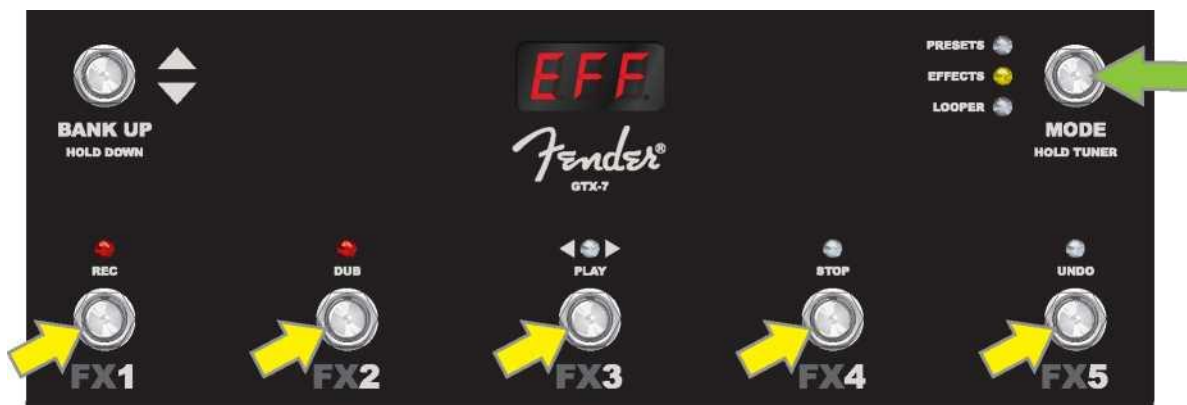
Esempio di modalità EFFECTS che mostra un preset con due effetti, ciascuno assegnato ai pulsanti FUNCTION FX1 e FX2. I LED rossi accesi della FUNCTION sopra FX1 e FX2 indicano, che entrambi gli effetti sono attivi; entrambi possono essere disattivati premendo i rispettivi pulsanti FUNCTION (funzione).
