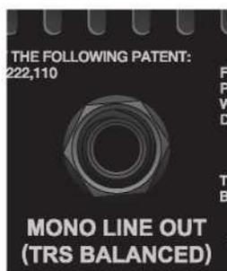
Quando si utilizza l'uscita di linea mono sul pannello posteriore, il controllo del livello si trova nella funzione LEVELS del menu a (*pagina 23*).
