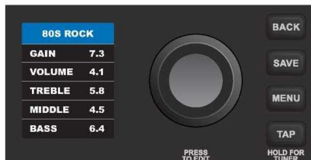
Esistono due modi per regolare l'impostazione della manopola di controllo dell'amplificatore. Un parametro di controllo che corrisponde ad una manopola fisica reale sul pannello di controllo, che si può regolare semplicemente girando la manopola reale, fino a quando si raggiunge il valore desiderato nella finestra DISPLAY WINDOW. Nell'esempio seguente, l'impostazione TREBBLE (alti) del modello di amplificatore si regola girando la manopola reale di controllo sul pannello di controllo:
