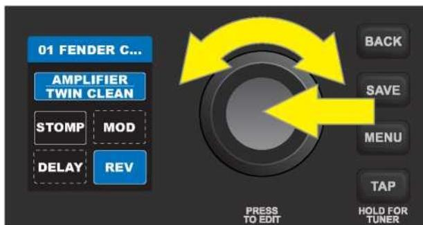
La finestra DISPLAY WINDOW quindi mostrerà un elenco dei controlli per il modello dell'effetto utilizzato in quella categoria; utilizzare ENCODER per scorrere fino ad un particolare effetto di controllo. Premere ENCODER per selezionare il controllo dell'effetto; la propria casella circostante passerà dal blu al rosso. Ruotare ENCODER per impostare un nuovo valore per il valore di controllo selezionato:
