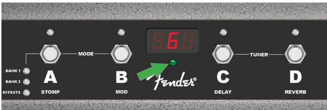
Qui, la nota "G" ha il pitch corretto, come indicato dall'illuminazione verde del LED al centro (freccia verde). Al termine dell'accordatura, premere un pulsante qualsiasi per uscire dalla modalità di accordatura con l'interruttore a pedale.
