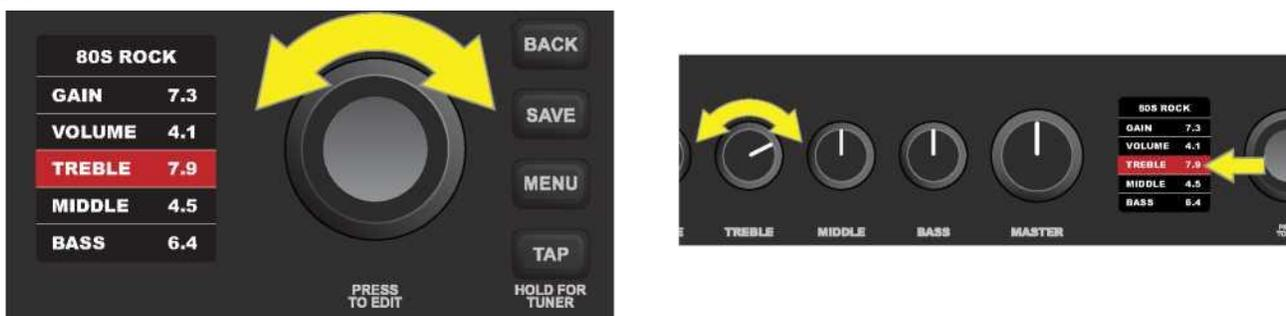
A questo punto, premere il pulsante ENCODER o BACK (freccia verde) per accettare i valori di controllo regolati. Premendo BACK si riporta l'utente alla schermata dei contenuti dei preset; premendo ENCODER si consente all'utente di continuare a modificare le impostazioni dei controlli e la casella che circonda l'impostazione dei controlli tornerà al blu. Al termine delle modifiche delle impostazioni di controllo, premere il pulsante SAVE per salvare le modifiche al preset.
