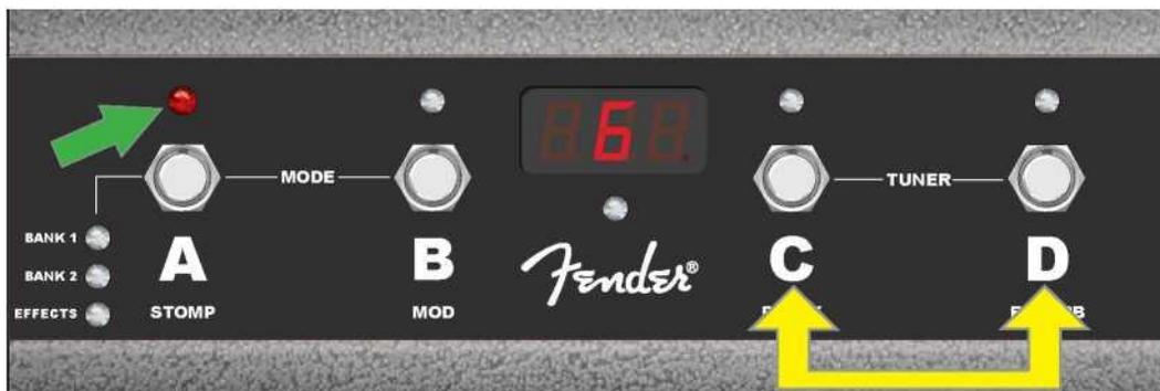
Per attivare la funzione dell'accordatura dell'interruttore a pedale, premere contemporaneamente i pulsanti "C" e "D" (doppia freccia gialla). Nell'esempio sopra, è visualizzata la nota "G" come particolarmente piatta, come indicato dall'illuminazione del LED rosso sopra il pulsante "A" (freccia verde).
