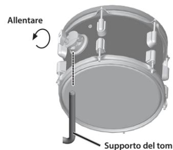
Diametro consentito dell'asta di montaggio: 9-13 mm
